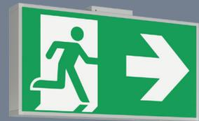
Moderne LED-Einzelbatterie-Rettungszeichenleuchte aus eloxiertem Aluminium, IP54 mit universellem Piktogramm-Set - Pfeil links/rechts/unten/blind. Bei der Wandmontage erfolgt die Installation über die Rückwand der Leuchte, bei der Deckenmontage über einen Adapter, welcher der Leuchte beiliegt. Zusätzlich verfügt die Leuchte über Lichtaustrittsfenster nach unten.
