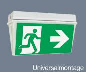
Schlagzähe LED-Einzelbatterie-Rettungszeichenleuchte im Polycarbonat-Gehäuse mit klarer Leuchtenhaube für Wandmontage und weißer Leuchtenhaube für Universalmontage (Wandparallel-/Deckenmontage), mit universellem Piktogramm-Set, IP65. Stoßfestigkeitsgrad IK10 nach IEC 62262 (Universalmontage) und IK8 (Wandmontage). IFS (International Food Standards) geprüft. Ballwurfsicher gemäß DIN 18032-3 (Wandmontage).
