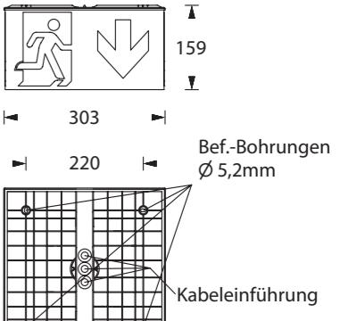
Gehäuseausführung 400 / Casing design 400 / Configuration logement 400
