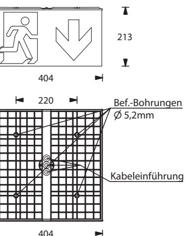
Gehäuseausführung 450\* / Casing design 450\* / Configuration logement 450\*
