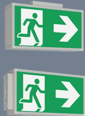
Moderne LED-System-Rettungszeichenleuchte aus eloxiertem Aluminium, IP54 mit universellem Piktogramm-Set - Pfeil links/rechts/unten/blind. Bei der Wandmontage erfolgt die Installation über die Rückwand der Leuchte, bei der Decken- und Auslegermontage über einen Adapter, welcher der Leuchte beiliegt. Zusätzlich verfügt die Leuchte über Lichtaustrittsfenster nach unten.
