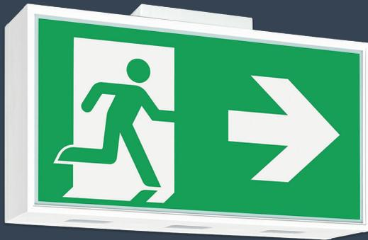
Moderne LED-Einzelbatterie-Rettungszeichenleuchte aus weißem Polycarbonat mit universellem Piktogramm-Set. Einfache, schraubenlose Montage durch Klick-System, IP54. Leuchte mit Lichtaustrittsfenstern nach unten.
