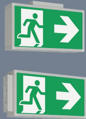
Moderne LED-Einzelbatterie-Rettungszeichenleuchte aus eloxiertem Aluminium, IP54 mit universellem Piktogramm-Set - Pfeil links/rechts/unten/blind. Bei der Wandmontage erfolgt die Installation über die Rückwand der Leuchte, bei der Decken- und Auslegermontage über einen Adapter, welcher der Leuchte beiliegt. Zusätzlich verfügt die Leuchte über Lichtaustrittsfenster nach unten.
